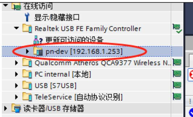
搜索出 SC7 3077-PNT22-COM 模块后，点击模块前边的箭头，双击“在线和诊断”，在弹出的窗口中进行模块参数的配置，如下图：
