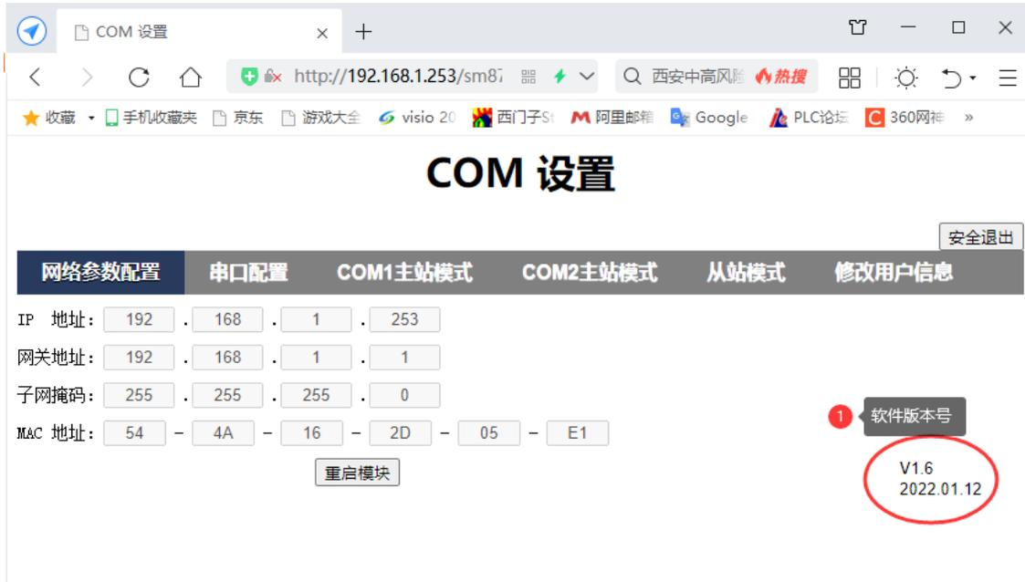
网络参数配置中可查看 SC7 3077-COM 模块的 IP 地址、网关地址，子网掩码、MAC 地址，这些参数不能修改。
