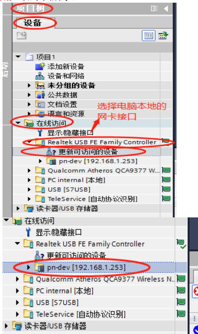
搜索出 SC7 3077-PNT22-COM 模块后，点击模块前边的箭头，双击“在线和诊断”，在弹出的窗口中进行模块参数的配置，如下图：
