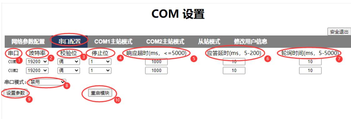
①串口：COM1（或 COM2）对应一个 RS-485 和 RS-232 串口，同一时刻只能选择一种串口方式通讯，COM1 与 COM2 是独立的两个串口，互不影响。
