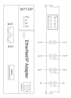
注: Us 为耦合器电源接线端, Up 为扩展模块电源接线端,使用时需要接 2 组电源。其中,③和④、⑤和⑥、⑦和⑧内部已短接,因此接③⑤⑦或④⑥⑧任意一组即可给扩展模块供电。
