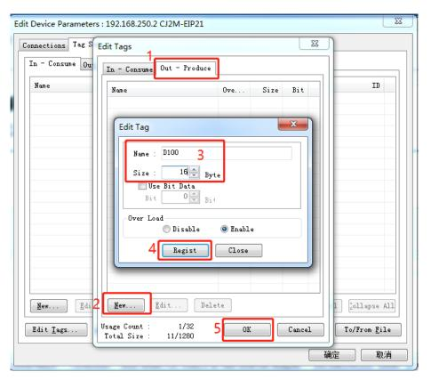
变量添加完成后,将 CPU 与 EIP 耦合器建立连接:
