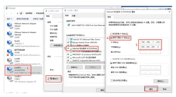
设置完电脑本地 IP 后,将 EIP 模块与电脑通过网线连接,打开浏览器(IE 浏览器或者 360 浏览器都可以),在地址栏中输入 192. 168. 1. 253,然后回车进入到 EIP 的网页参数设置页面,如下图所示:
