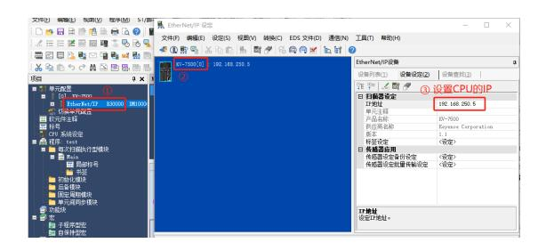
双击打开 EtherNet/IP 网络配置,在 EtherNet/IP 设定界面打开 "EDS 文件"→"登录",选择需要安装的 EDS 文件:
