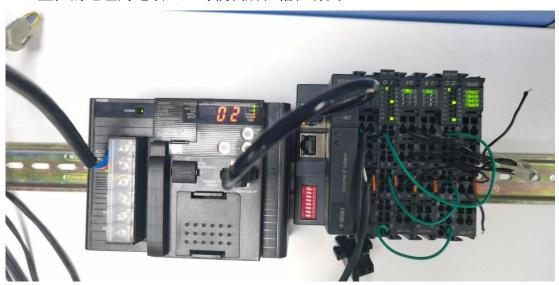
此例放置的顺序为: 3021-1NH, 3031-7PB, 3032-0VD, 3022-1NH, 3022-1BF, 将 3022-1NH 的 bit0, bit7, bit15 分别接到 3021-1NH 的 bit0, bit7, bit15, 监控如下:
