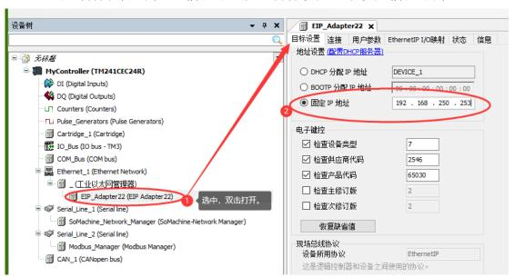
4、双击打开添加的 EIP 耦合器添加连接,并设置输入/输出的数据长度,连接类型选择"点对点",在下方的配置数据中填写实际的模块个数:
