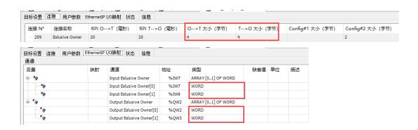
(2) 如果输入/输出的字节长度为奇数时,在"Ethernet IP I/O 映射"显示的 IO 变量类型为 byte,如下所示:
