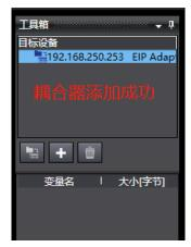
耦合器添加成功后,需要配置输入、输出数据长度,以及填写 Ⅰ○ 个数:
