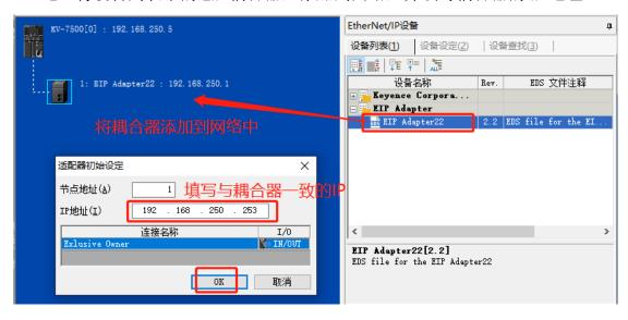
2、依次打开 "Exclusive Qwner" → "参数设定", 在参数设定窗口填写输入和输出的字节长度, 并填写模块个数:
