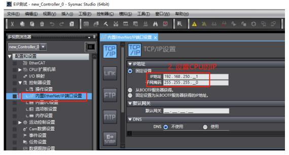
打开"工具"→"打开 EtherNet/IP 连接设置",配置 EtherNet/IP 连接设置:
