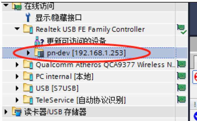
搜索出 SC7 3077-PNT 模块后，点击模块前边的箭头，双击“在线和诊断”，在弹出的窗口中进行模块参数的配置，如下图：
