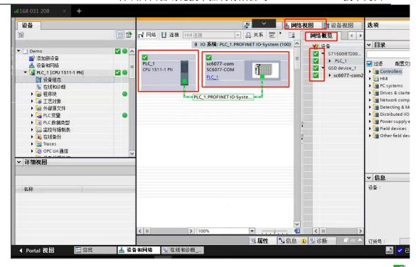
将硬件组态下载到 S7-1500CPU 后,点击"转至在线",看"网络概览"中设备都是状态时,说明硬件组态正确,模块运行正常。
