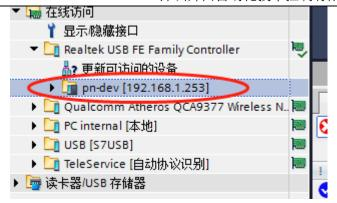
搜索出 SC5 6077-PNT22-COM 模块后,点击模块前边的箭头,双击"在线和诊断",在弹出的窗口中进行模块参数的配置,如下图:
