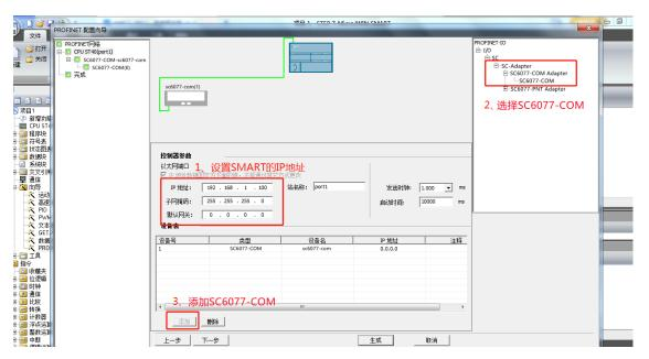
添加 6077-PNT22-COM 模块之后,需要设置填入模块的 IP,以及模块 Porfinet 设备名称,此时填写的 IP 和设备名称均需要与 SC6077 网页设置的保持一致,否则连接失败:
