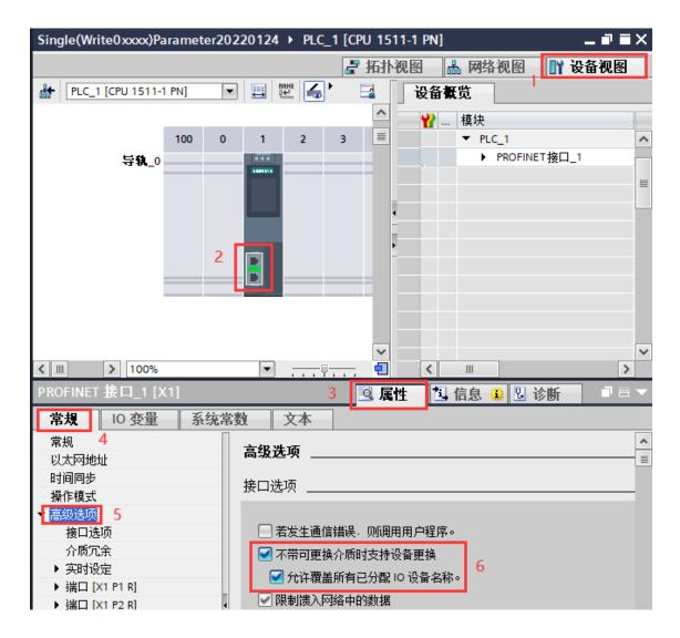
2、然后操作和上面③组态硬件一样的操作,只是设置 IP 可以自行设置, 名称可以勾选自动生成 PROFINET 设备名称。然后把工程下载进去之后,PLC 会 把设置的 IP 和名称覆盖耦合器原有的名称和 IP, 自动匹配通讯上。
