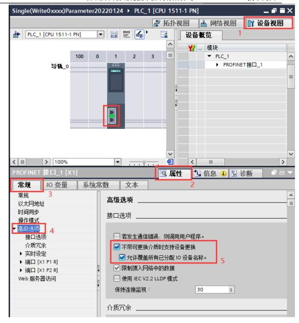
2、然后操作和上面③组态硬件一样的操作,只是设置 IP 可以自行设置, 名称可以勾选自动生成 PROFINET 设备名称。然后把工程下载进去之后,PLC 会 把设置的 IP 和名称覆盖耦合器原有的名称和 IP,自动匹配通讯上。
