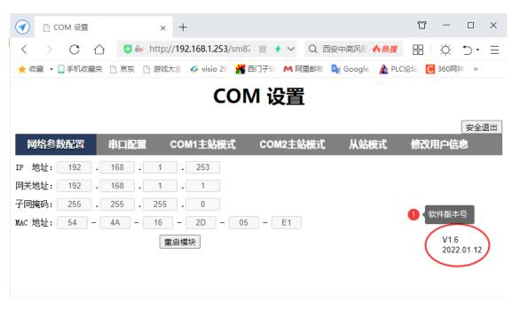
网络参数配置中可查看 SC6077-COM 模块的 IP 地址、网关地址,子网掩码、MAC 地址,这些参数不能修改。
