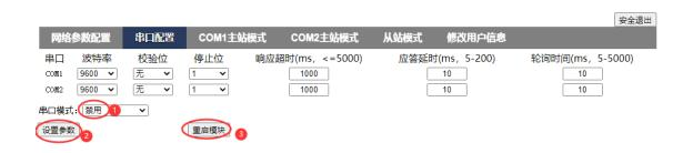
注意: "串口配置"参数配置好后需要把 SC6077-COM 耦合器模块断电重启,模块才能正常使用。
