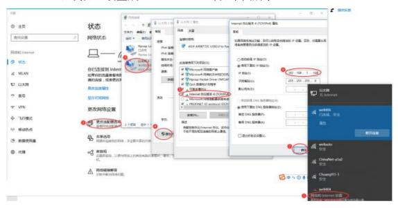
电脑 IP 网段配置好后,打开浏览器,SC5 6077-PNT22-COM 模块上电,在浏览器的地址栏中输入"192.168.1.253:2250"登录到网页参数配置页面,如下图所示:
