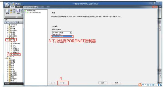
设置 PLC 的 IP 及网关地址,并添加 SC6077-PNT-COM 模块:
