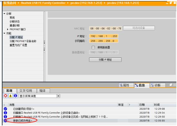
按照相同的方式配置 SC5 6077-PNT22-COM 模块的设备名称,如下图所示:
