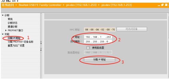
分配 IP 成功时,博图软件会在软件窗口的右下角或者"常规"选项中的"消息"里显示"参数已成功传送",如下图所示:
