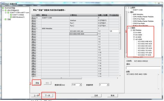
设置 SC5 6032-0VD 的输出量程:
