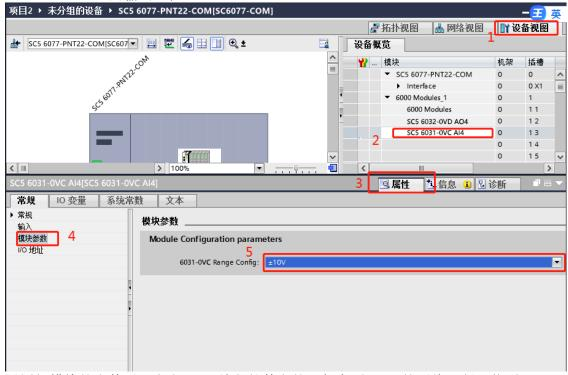
设置好模块的参数后,点击 TIA 编程软件上的"保存项目",然后将工程下载到 CPU 中。查看模块的数据地址:
