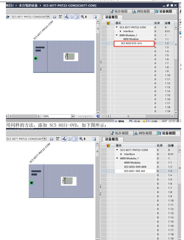
设置 SC5 6032-0VD 的输出量程:
