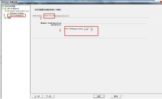
设置好模块的参数后,点击 SMART 编程软件上生成,然后将工程下载到 CPU 中。查看模块的数据地址:
