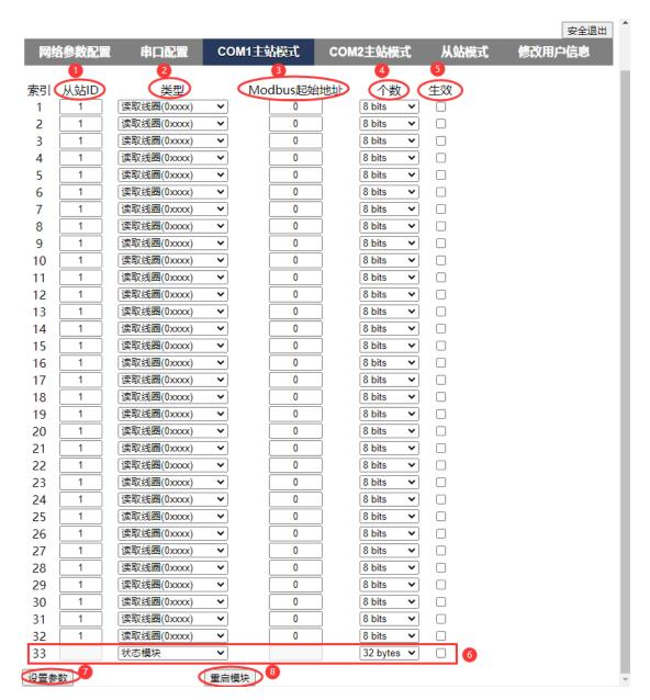
COM1 主站模式、COM2 主站模式参数配置项相同,在此以 COM1 主站模式配置 页面来说明,COM2 主站模式可参考 COM1 主站模式来进行参数配置
