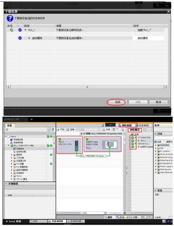
将硬件组态下载到 S7-1500CPU 后,点击"转至在线",看"网络概览"中设备都是状态时,说明硬件组态正确,模块运行正常。
