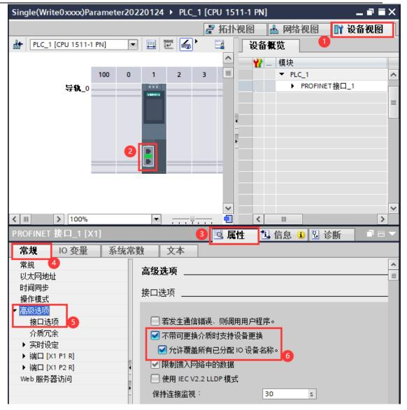
2、然后操作和上面③组态硬件一样的操作,只是设置 IP 可以自行设置, 名称可以勾选自动生成 PROFINET 设备名称。然后把工程下载进去之后,PLC 会 把设置的 IP 和名称覆盖耦合器原有的名称和 IP,自动匹配通讯上。
