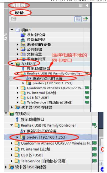
搜索出 SC5 6077-PNT22-COM 模块后,点击模块前边的箭头,双击"在线和诊断",在弹出的窗口中进行模块参数的配置,如下图:
