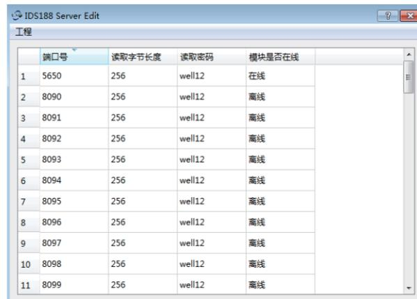
注：组态王等组态软件建议选择S7 TCP/IP协议，Wincc组态软件必须选择Modbus TCP/IP协议。通信IP地址都固定为127.0.0.1。
