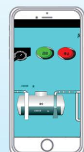
第三步：将第二步中的运行文件通过移动端软件 wellviewmobile 的“接收工程”或微信的“文件传输助手”上传到移动端设备，并启动在线运行。这时在移动端设备上就可以查看远程设备的数据、控制设备状态。
