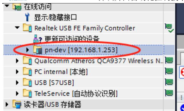
搜索出 SC6077-PNT 模块后，点击模块前边的箭头，双击“在线和诊断”，在弹出的窗口中进行模块参数的配置，如下图：
