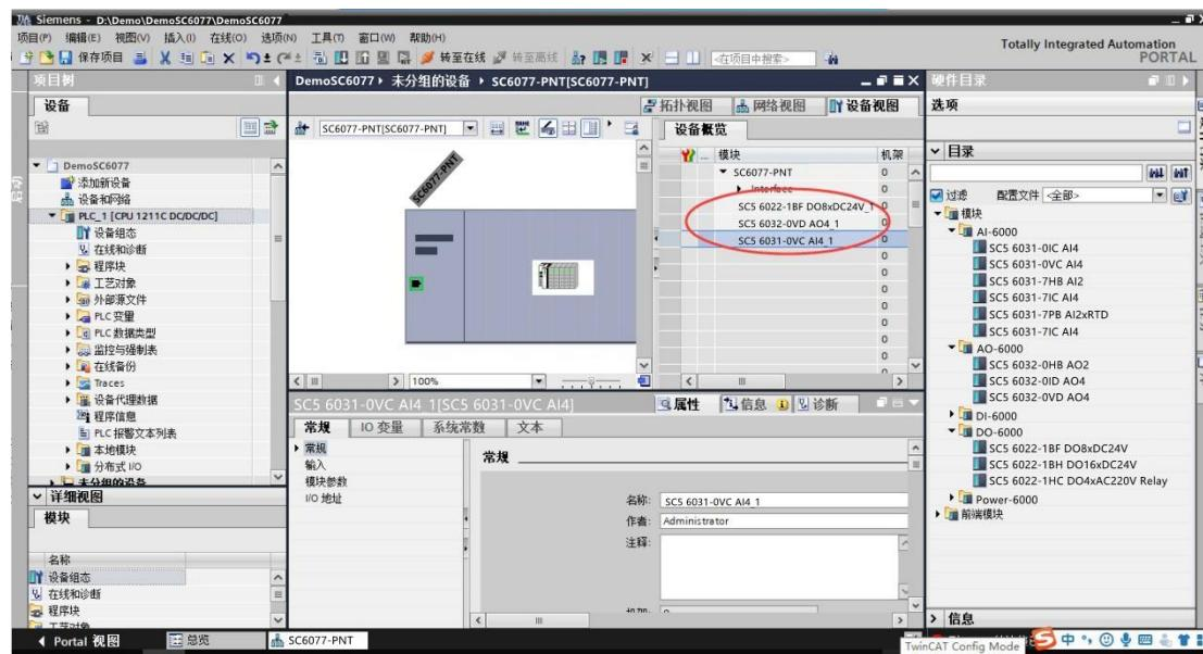
设置 SC5 6032-0VD 的输出量程：
