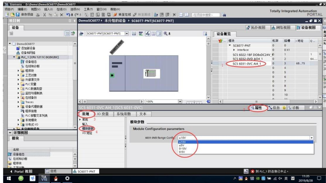
设置好模块的参数后，点击 TIA 编程软件上的“保存项目”，然后将工程下载到 CPU 中。
