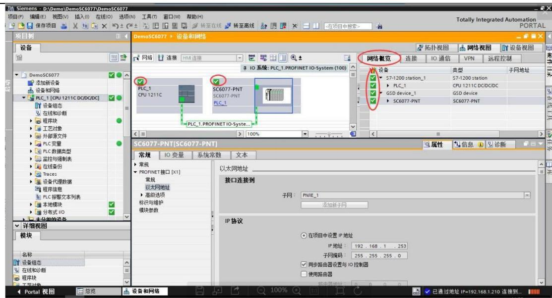
将硬件组态下载到 S1200CPU 后，点击“转至在线”，看“网络概览”中设备都是状态时，说明硬件组态正确，模块运行正常。
