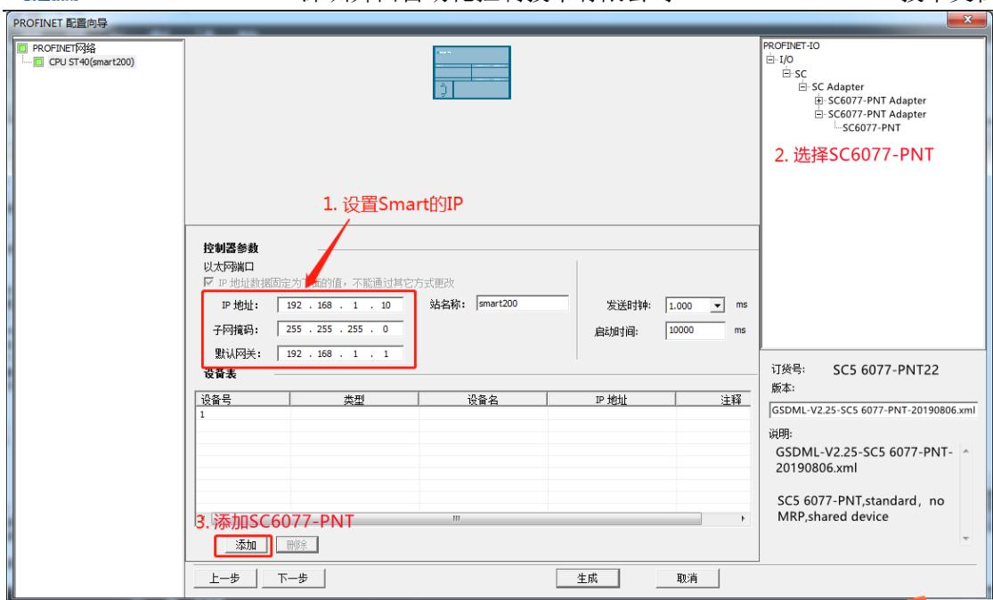
添加 6077-PNT 模块之后，需要设置填入模块的 IP，以及模块 Porfinet 设备名称，此时填写的 IP 和设备名称均需要与 SC6077 网页设置的保持一致，否则连接失败：
