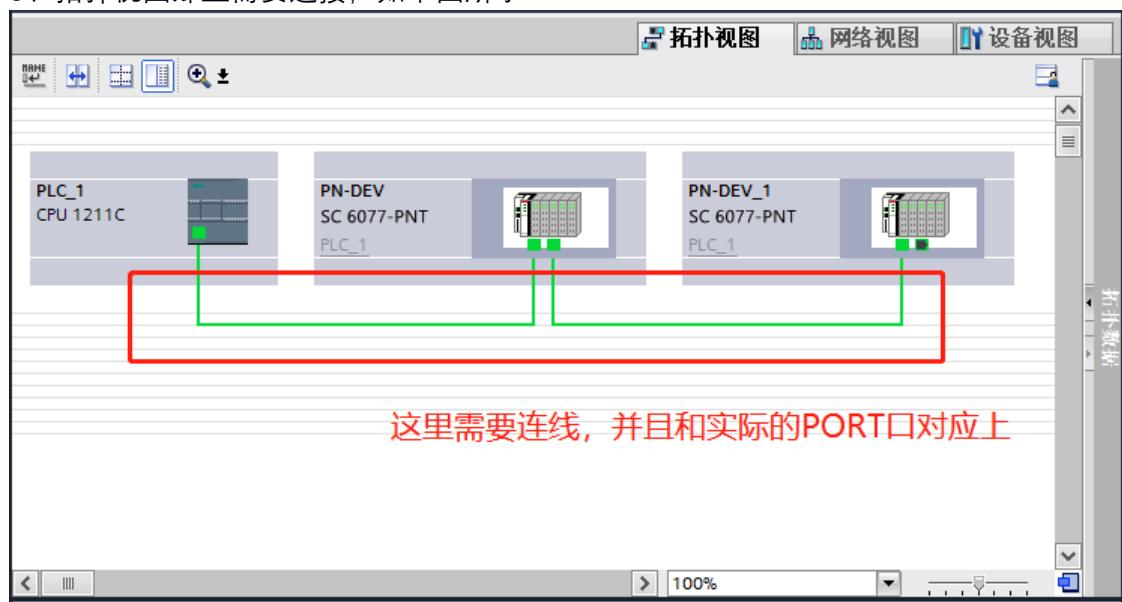
4、如上图博途软件里面的拓扑组态和实际硬件的网线连接端口 1 和端口 2 的顺序必须对应上,否则网络会报错。
