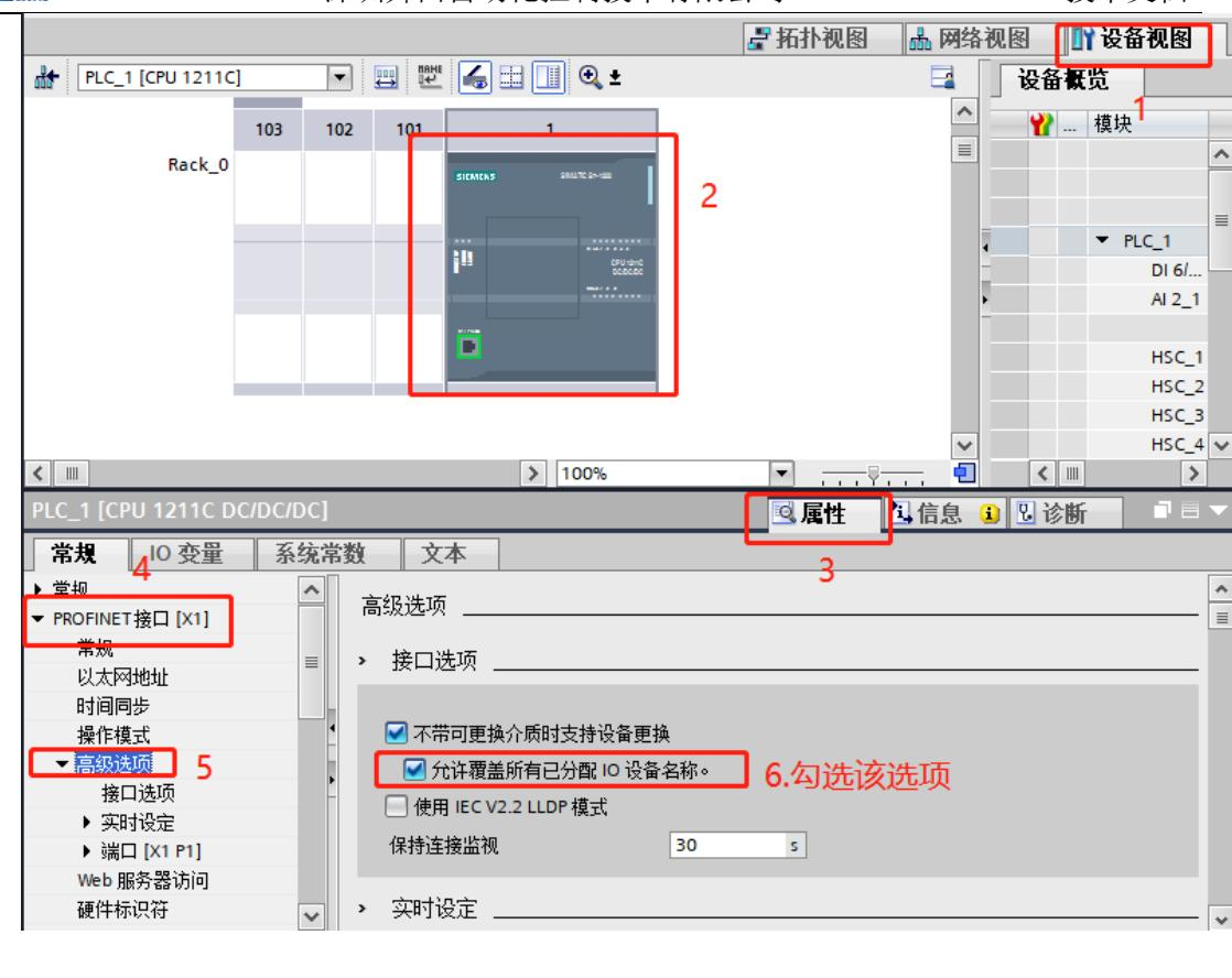
选中此选项时，IO 控制器（CPU 的 PROFINET 接口）可覆盖 IO 设备的 PROFINET 设备名称。这样可以减少自动调试的工作量，例如在更换设备时。
