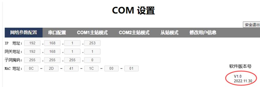
网络参数配置中可查看 SC7 3041-COM 模块的 IP 地址、网关地址，子网掩码、MAC 地址，这些参数不能修改。
