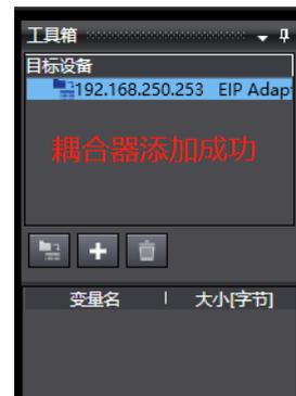
耦合器添加成功后，需要配置输入、输出数据长度，以及填写 IO 个数：
