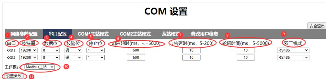
①串口：COM1（或 COM2）对应一个 RS-485、RS-422/RS-232 串口，同一时刻只能选择一种串口方式通讯，COM1 与 COM2 是独立的两个串口，互不
