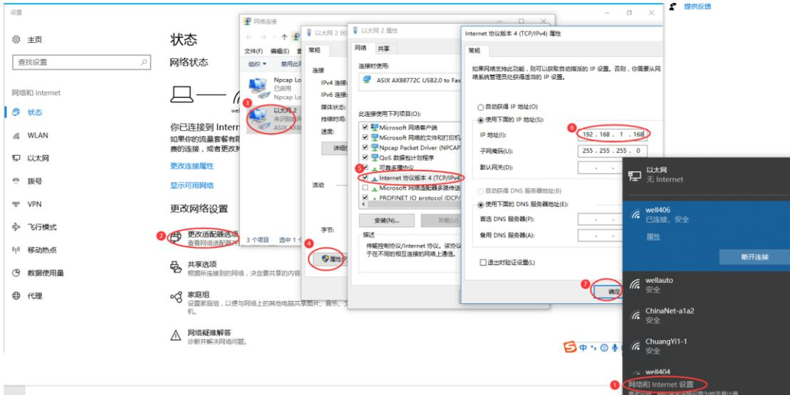
设置好电脑的 IP 地址后，电脑上打开浏览器，在浏览器的地址栏中输入 192.168.1.253:2250，登录到网页参数配置页面，如下图所示：
