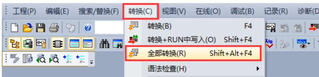
②下载整个工程到 Fx-5U，程序下载完成后需要将 CPU 重启：
