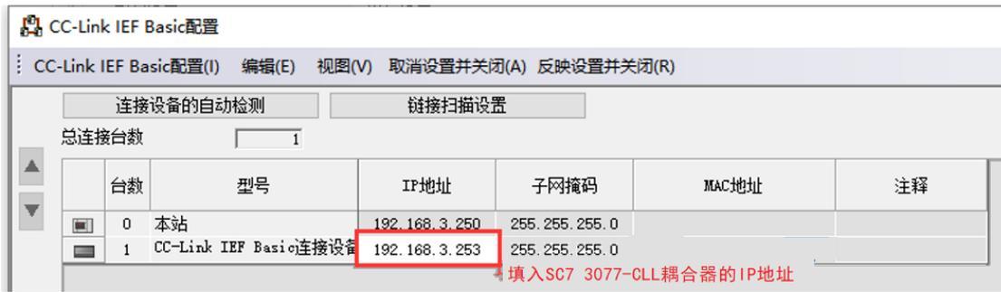
设置完成后，点击【反映设置并关闭】关闭此配置窗口。
