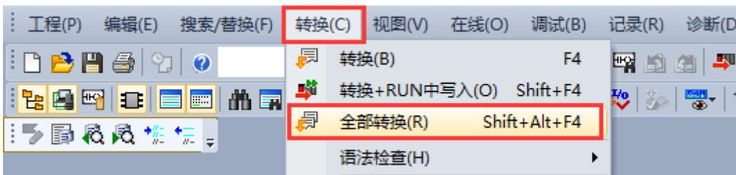
②下载整个工程到 Fx-5U，程序下载完成后需要将 CPU 重启：
