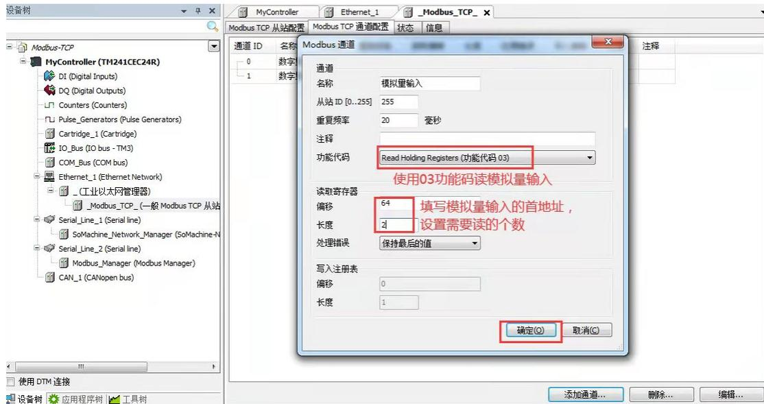
5、读写的地址配置好之后，将程序下载到控制器，点亮 DO 模块，且 3022-1NH 的 Q0.0 和 Q0.1 分别接到 3021-1NH 的 I0.2 和 I0.3:
