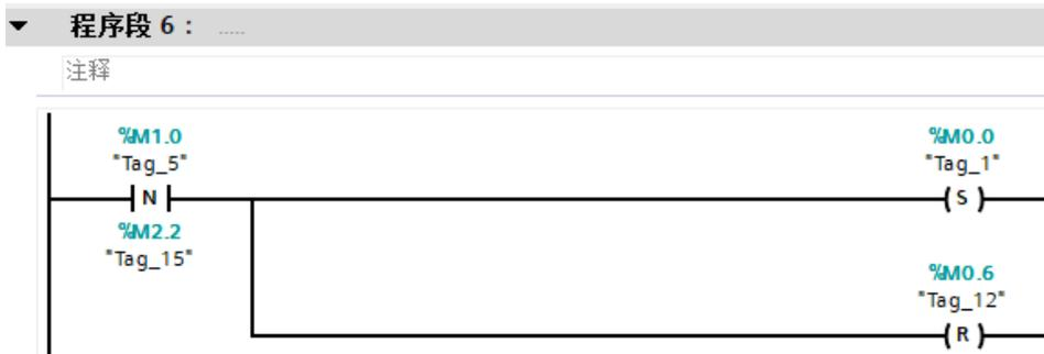
写好程序后，把工程下载到 CPU 中，然后将程序中 M0.0 置位，使程序运行，运行结果如下：
