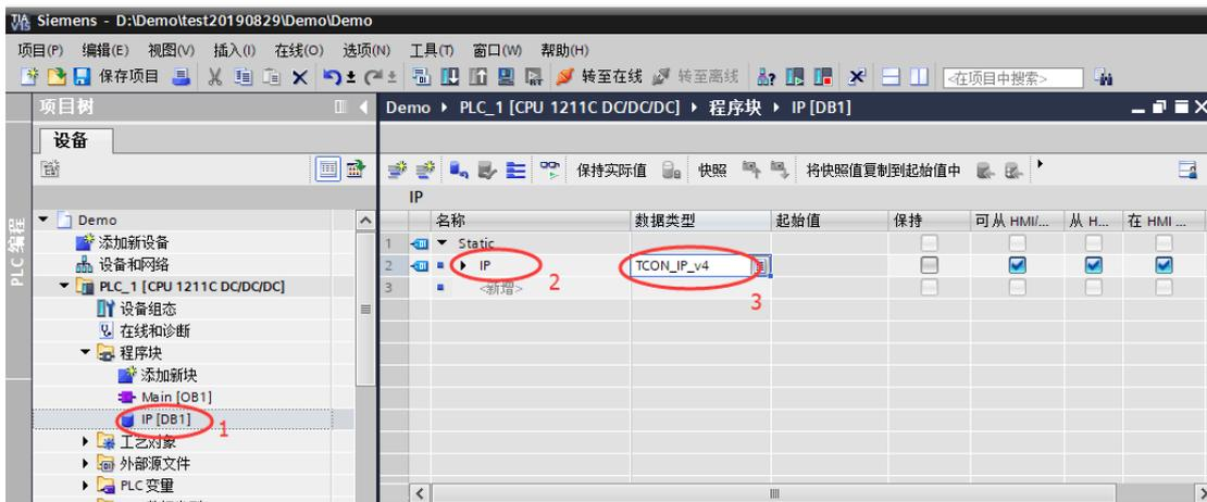
将“IP”前的箭头点开，进行通讯参数配置，如下图所示：
