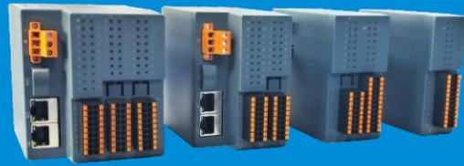
SC2000系列分布式IO产品，是舜昌自动化针对数据检测点多，性价比要求高的行业推出的方案，是一种基于通信网关的分布式IO检测单元。主要有数字量输入，输出模块、模拟量输入，输出模块、温度测量模块、耦合器模块，种类多，配置灵活。单个产品容量大、性价比极高。
